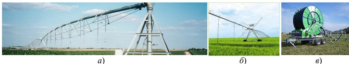
а – поливочная машина с центральным приводом (кругового действия);
