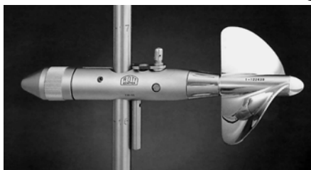
Рис. 7. Универсальный ИСП С-31 (материалы винта: Л – латунь, П – пластик, А – анодированный алюминий, ОТТ-Hydrometrie, г. Кемптен, Германия) (по [18])
