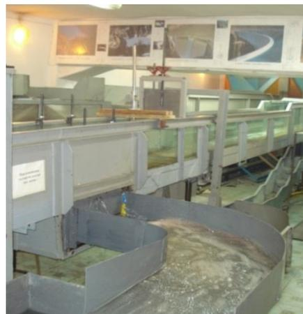
1 – успокоительный бак; 2 – ГЛЛ; 3 – модель ВДКБТ; 4 – отводящие каналы (лотки);
