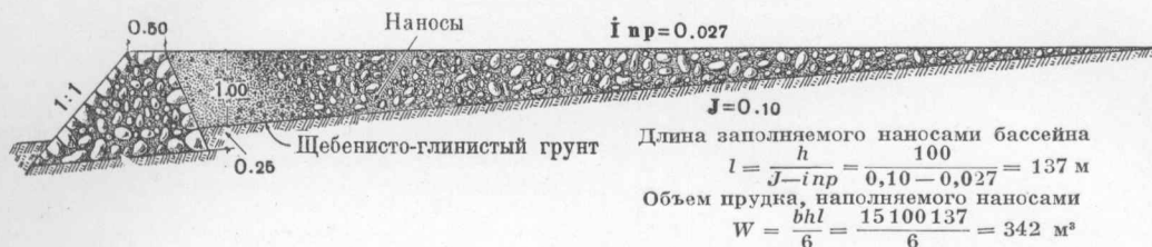
Рис. 20. Схема действия запруды по задержанию твердого расхода. ВНИЛАМИ, Горная экспедиция.
