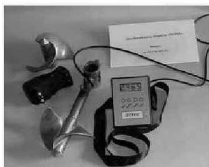
Рисунок 2 – Гидрометрическая вертушка с измерителем-регистратором ИСП-1М
