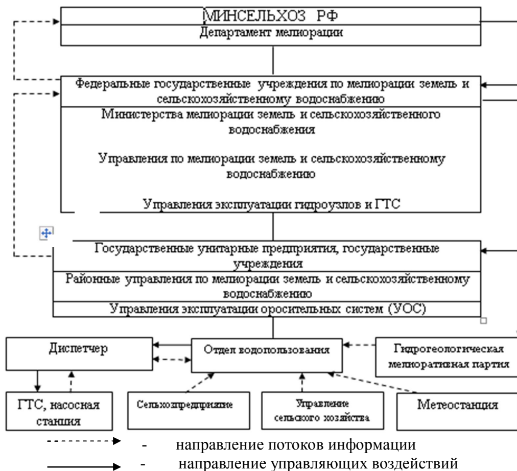
Рисунок 2 – Информационные потоки при управлении водораспределением
