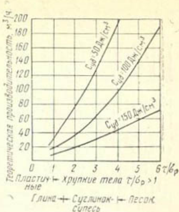
Рис. 5.4. Зависимость производительности вибровальцовых рыхлителей от показателя пластичности мерзлых грунтов.
