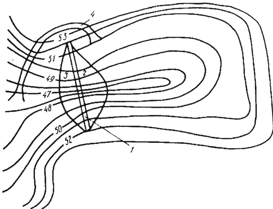
**Рис. 65.** План балки с плотиной и водосливом:
