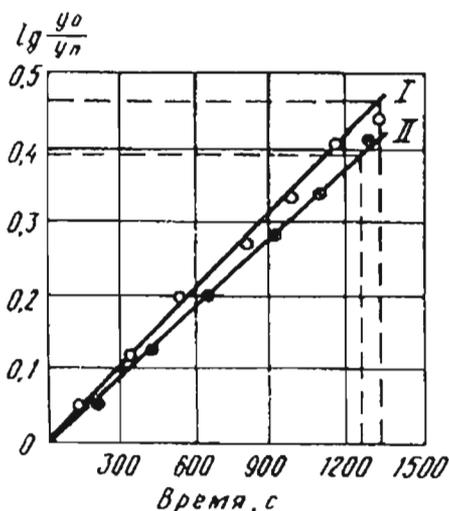
Рис. 24. Определение тангенса при расчете коэффициентов фильтрации
