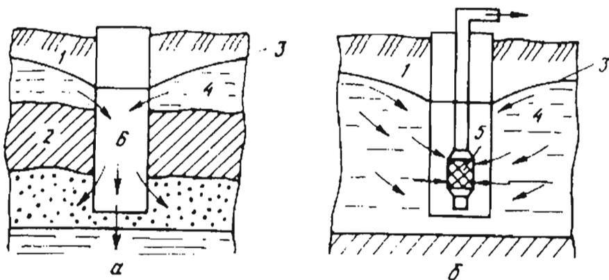
**Рис. 52.** Осушение с помощью водопоглощающих колодцев (а) и с откачкой воды из скважин (б):
