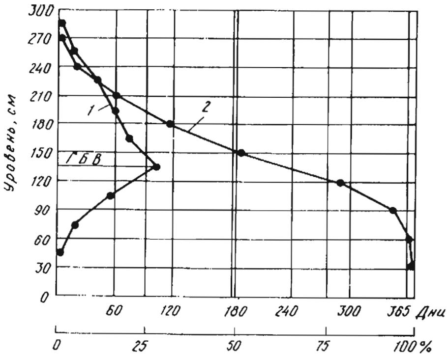
Рис. 14. Графики частоты (1) и обеспеченности (2) уровня воды
