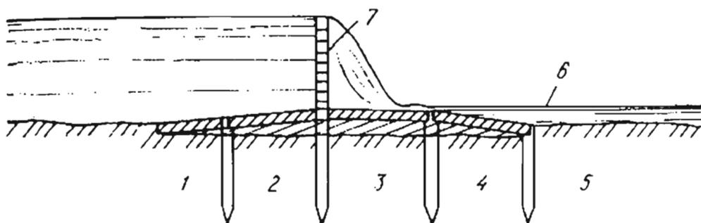
Рис. 66. Схема водоспуска в теле плотины:
