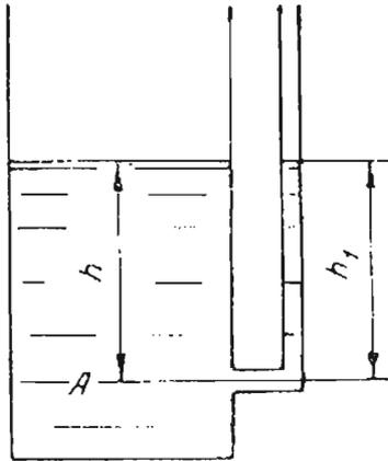
Рис.4. Схема формирования пьезометрического напора
