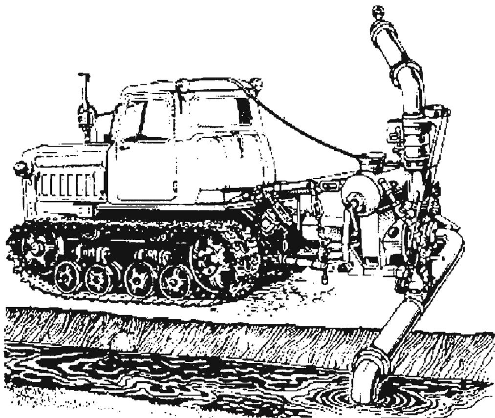
**Рис. 92.** Общий вид дождевальной машины ДДН
