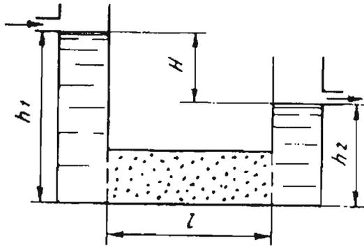
Рис. 22. Схема опыта по проверке закона Дарси
