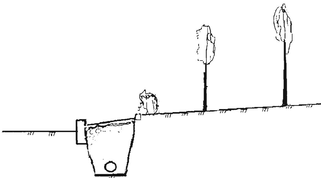
**Рис. 55.** Защитная зона с дренажем вдоль бульвара
