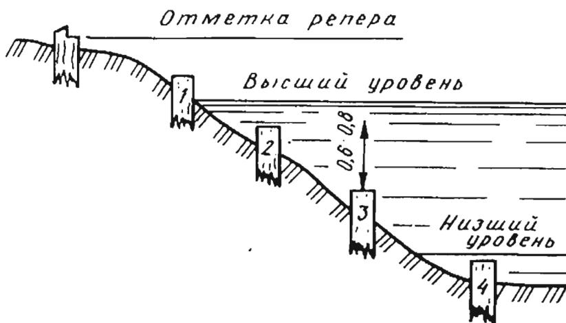
Рис. 10. Свайный водомерный пост:
