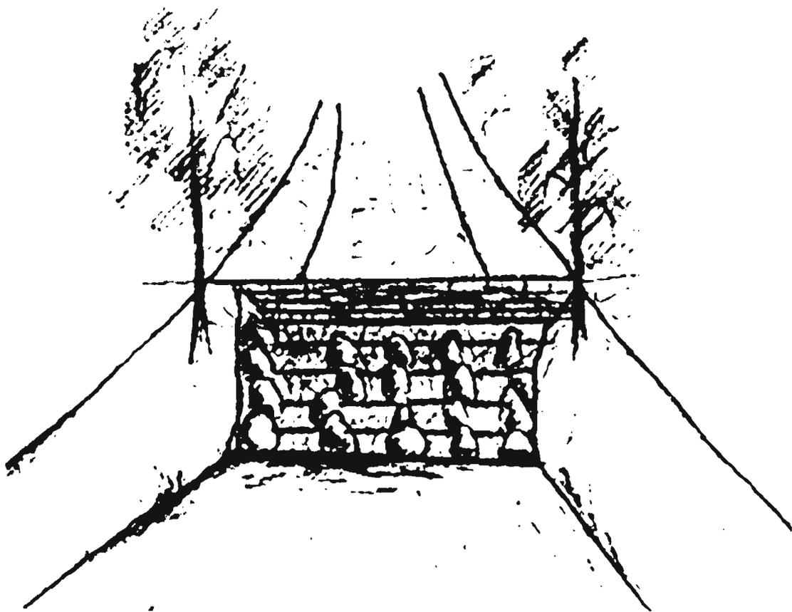
Рис. 67. Схема сброса воды через гребень плотины
