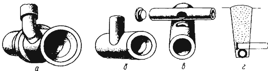
**Рис. 47.** Способы сопряжения дрен и коллекторов:
