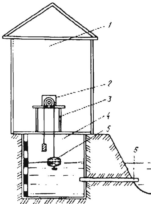
**Рис. 11.** Схема установки самописца берегового типа:
