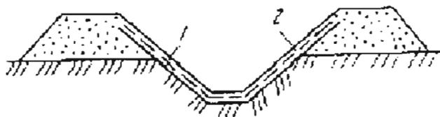
**Рис. 100.** Антифильтрационная одежда канала из полиэтиленовой пленки:
