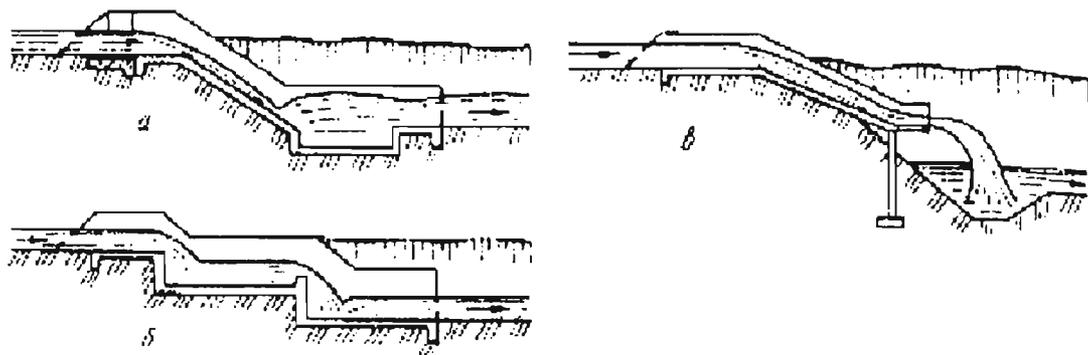
Рис. 102. Гидротехнические сооружения в вершине оврагов:
