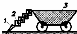
Рис. 1.1.3. Корчеватель-бульдозер-погрузчик КБП-2 ( d_k < 100 см)
