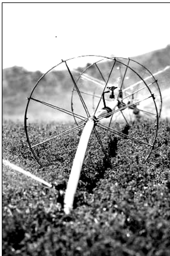
Рис 7.5. Дождеватель колесный широкозахватный ДКШ-64 “Волжанка”.
