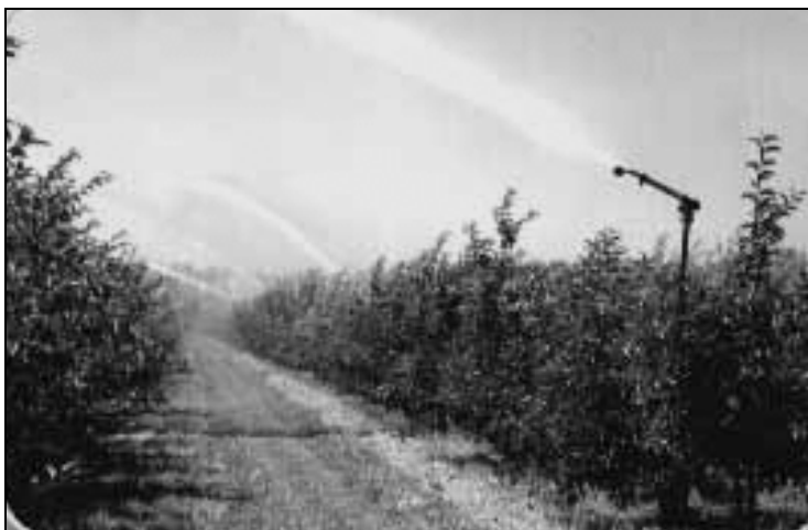
Рис. 6.2. . Дождевальный аппарат ДД-30 на трубопроводе:
