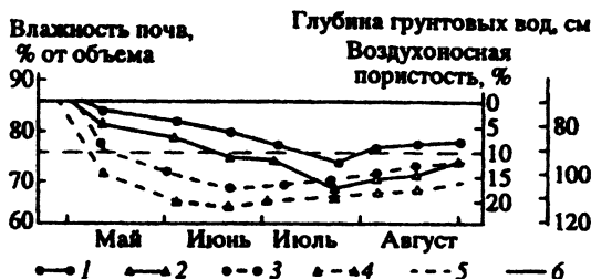
Рис. 31. Изменение воздухоносной пористости, динамика влажности (на глубине 80 см) и грунтовых вод осушенных торфяных почв на черной и покровной культурах в 1995 г. Объемная влажность: 1 — черная культура; 2 — покровная культура. УГВ: 3 — черная культура; 4 — покровная культура; 5 — 10% воздухоносной пористости; 6 — полная влагоемкость
