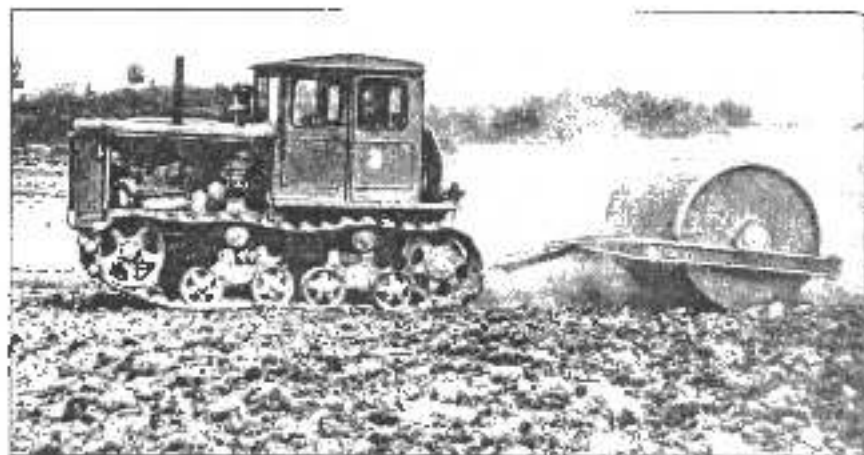
Рис. 45. Прикатывание торфяных почв водонасыщенным катком для восстановления гидрологической связи пахотного и подпахотного горизонтов в осушенных торфяных почвах
