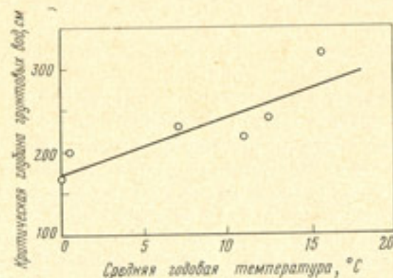
Рис. 3. Зависимость критической глубины грунтовых вод от среднегодовой температуры
