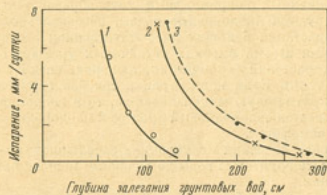
Рис. 1. Зависимость интенсивности испарения грунтовых вод от глубины залегания их уровня:
