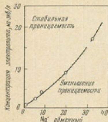
Рис. 19. Концентрация электролита, необходимая для поддержания проницаемости почв при различном содержании обменного Na + (Quirk, Schofield, 1955)
