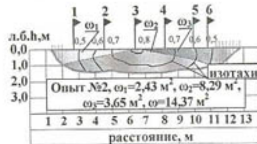
Рисунок 2 - Распределение продольных скоростей потока в изотахах (Большой Алматинский канал ПК954, продолжение рисунка).
