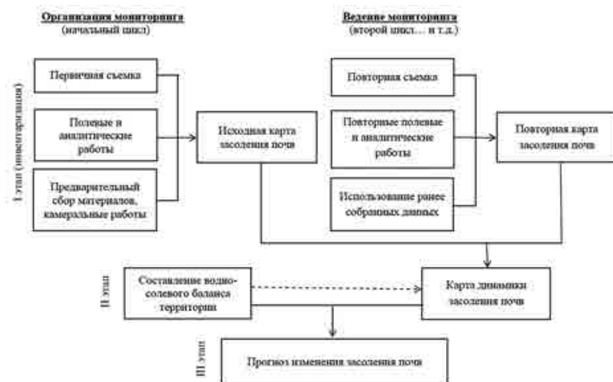
Рисунок 2.1. Общая схема дистанционного мониторинга засоления орошаемых почв [15]
