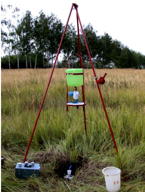
Рис. 2. Портативная ДУ с площадью стоковой площадки 0.05 м 2 .
