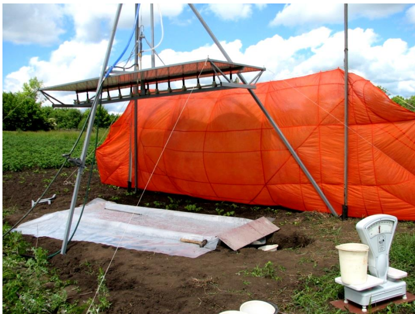
Рис. 1. Большая ДУ с площадью стоковой площадки 3 м 2 .
