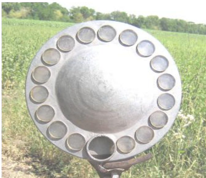
Рис. 12. Прибор для получения отпечатков водяных капель КР-2
