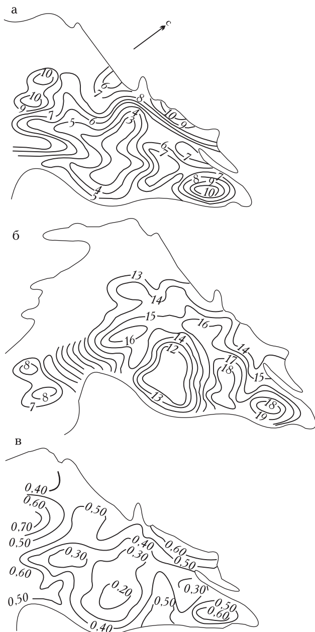
Рис. 31. Приток тепла вследствие турбулентного тепло- и влагообмена (P+LE) (а), затраты тепла на таяние rW (б) и отношение (P+LE)/rW (в) на леднике ИГАН за период с 23 июля по 3 сентября 1959 г., ккал/см 2 (Адаменко, 1968)
