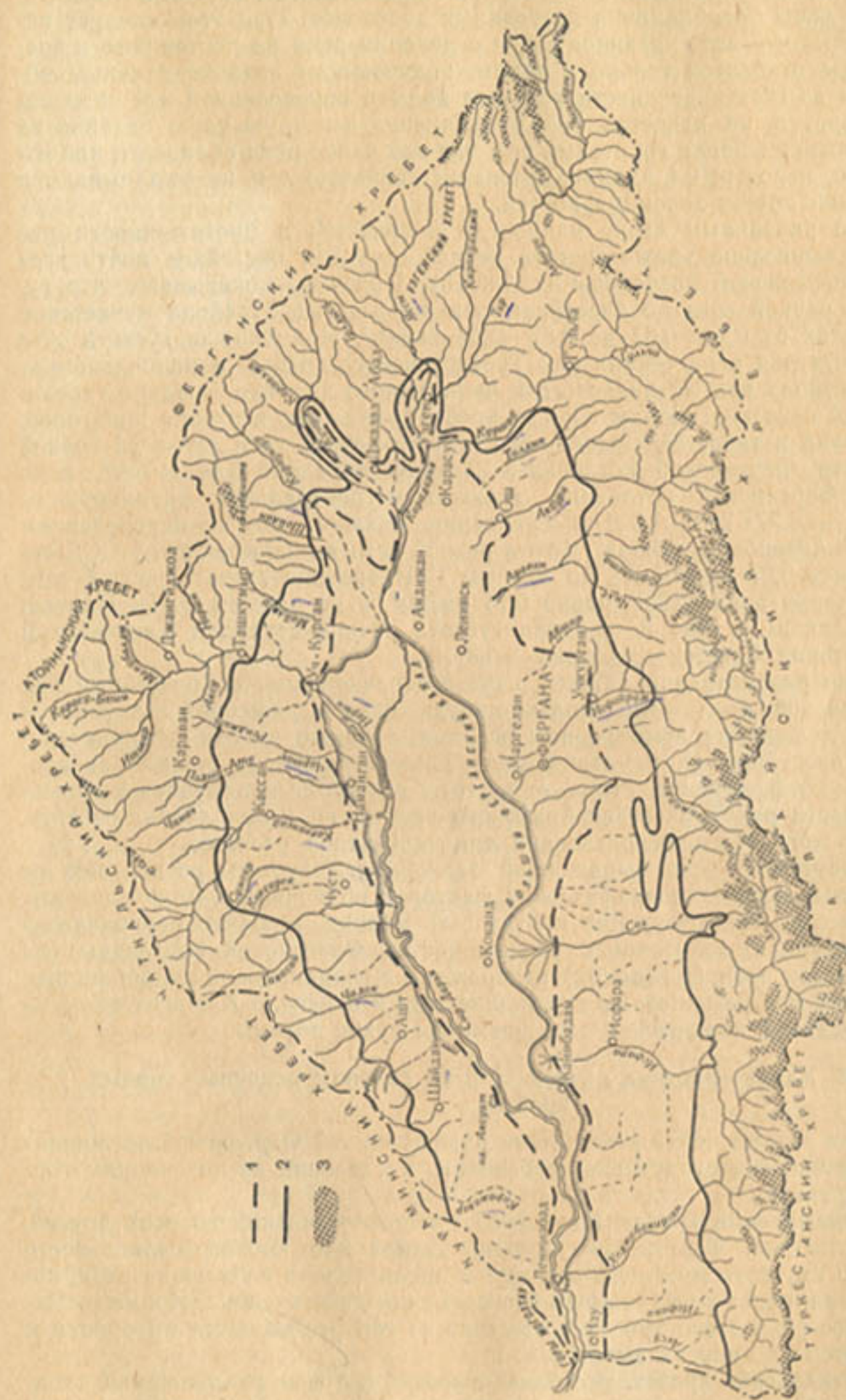
Рис. 19. Схема деления Ферганской котловины на зоны с различными гидрологическими свойствами.
