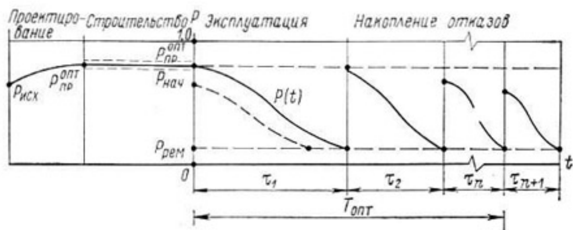
Рис. 9. Схема реализации эксплуатационной надежности закрытого дренажа ( \tau_1, \tau_2, \tau_{n+1} — отрезки времени для завершения расчетного цикла надежности)
