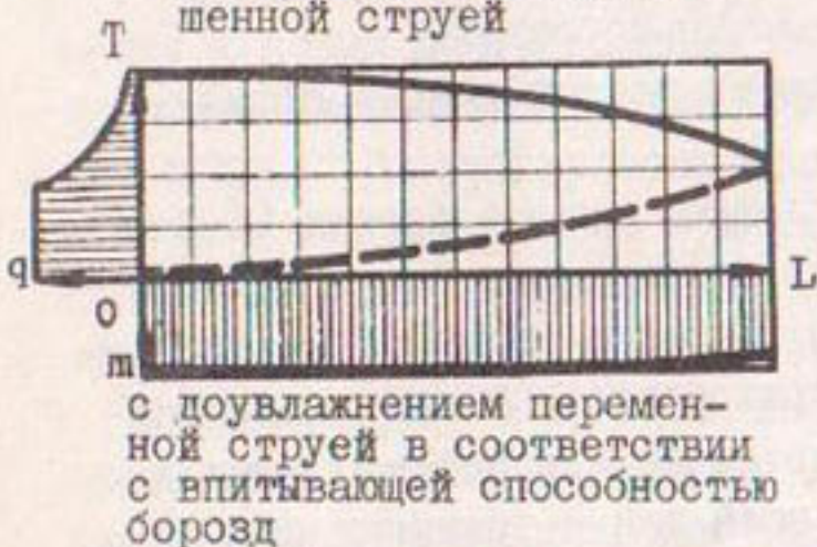
Рис. I. Циклограммы разновидностей технологии водораспределения (по тупым и проточным бороздам): T - продолжительность; L - длина борозды; q - поливная струя; m - поливная норма; — время увлажнения; - - - время добегаания
