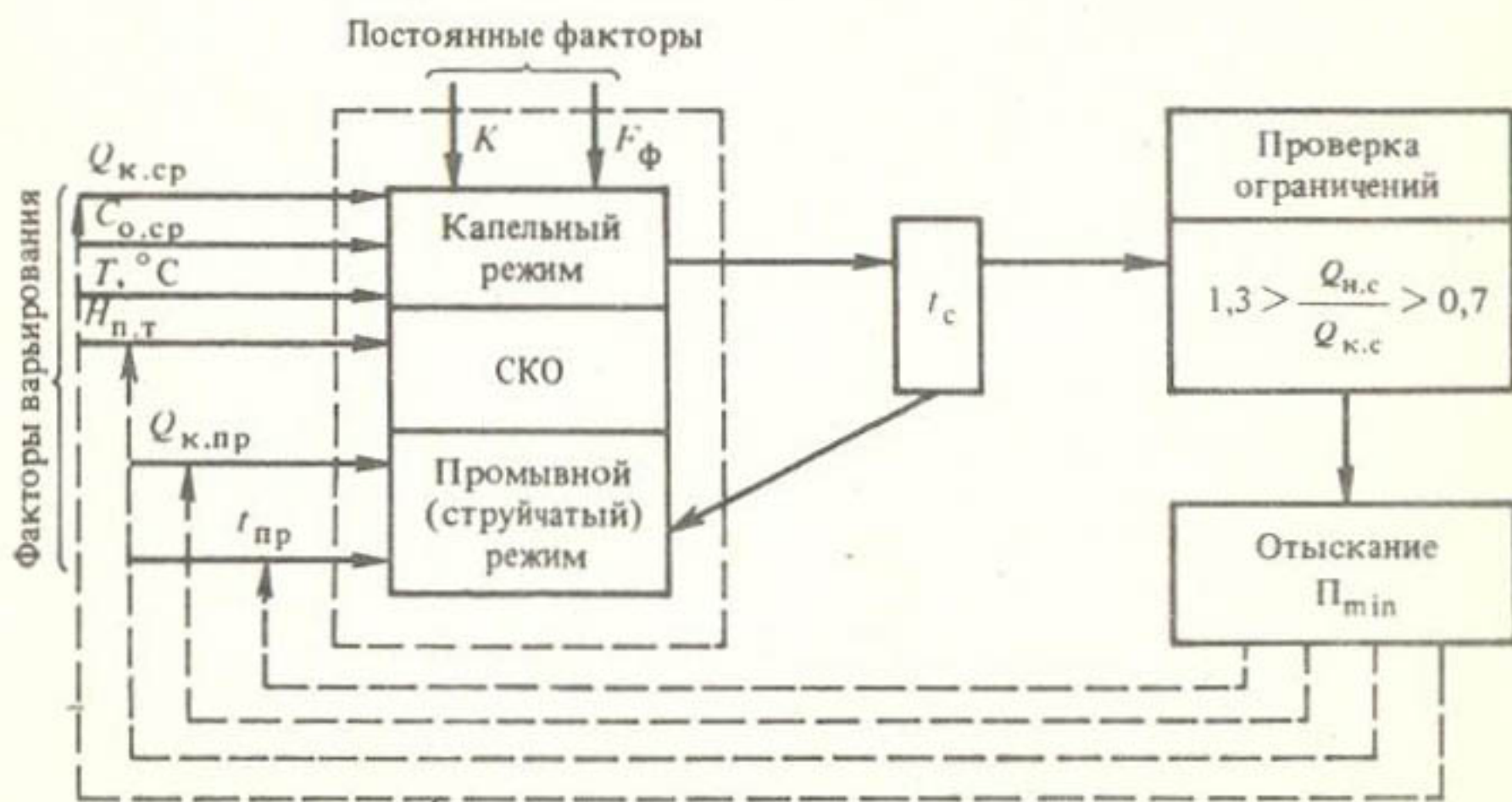
Рис. 2. Структурная схема оптимизации работы поливной сети СКО
