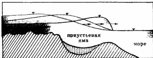
Схема образования приустьевой ямы.
