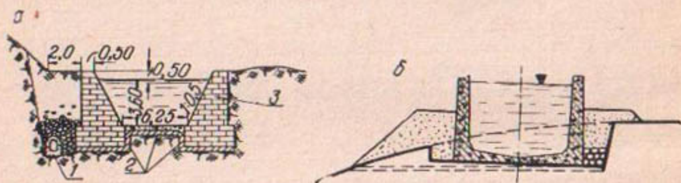
Рис. 44. Лотки на сплошных основаниях:
