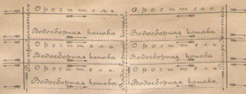
Черт. 41. Схема, показывающая примерное взаимное расположение распределителей, оросителей, водосборных канав и водосбросных каналов.
