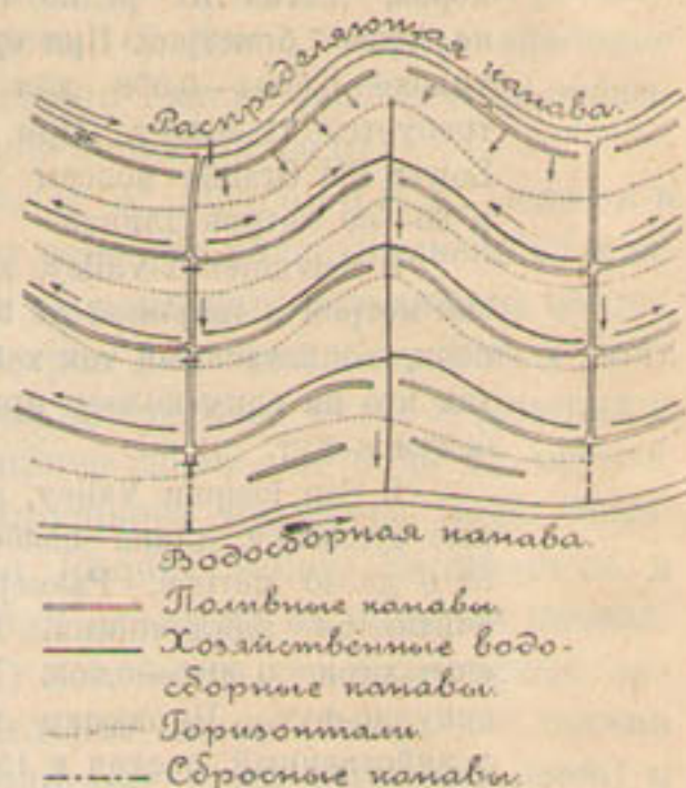
Черт. 245. Односкатная естественная система в волнистой местности с водосборными канавами на каждой делянке.
