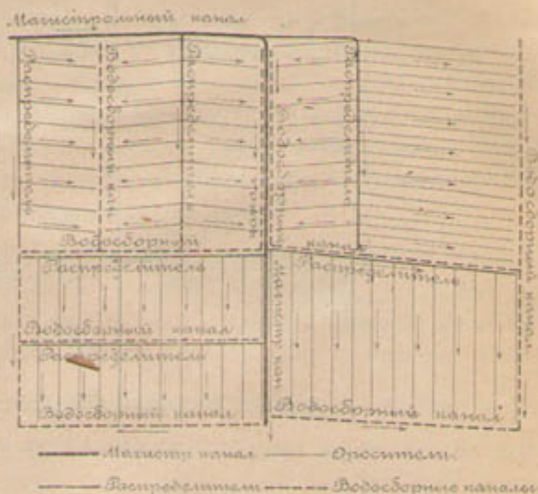
Черт. 186. Схема разбивки сети по комбинированному типу.
