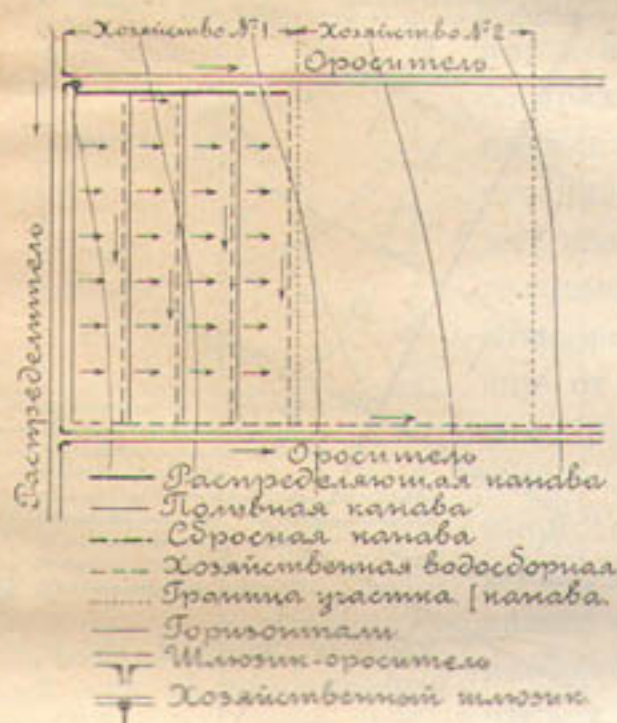
Черт. 217. Разбивка мельчайшей сети на поселенческом участке при равномерном уклоне местности.
