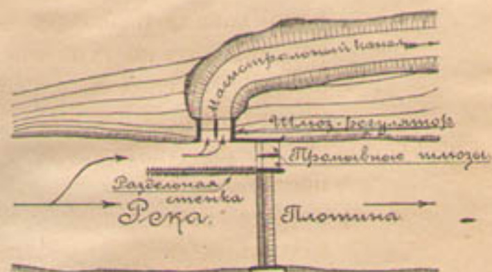
Черт. 24. Водоподъемная плотина со шлюзом-регулятором.
