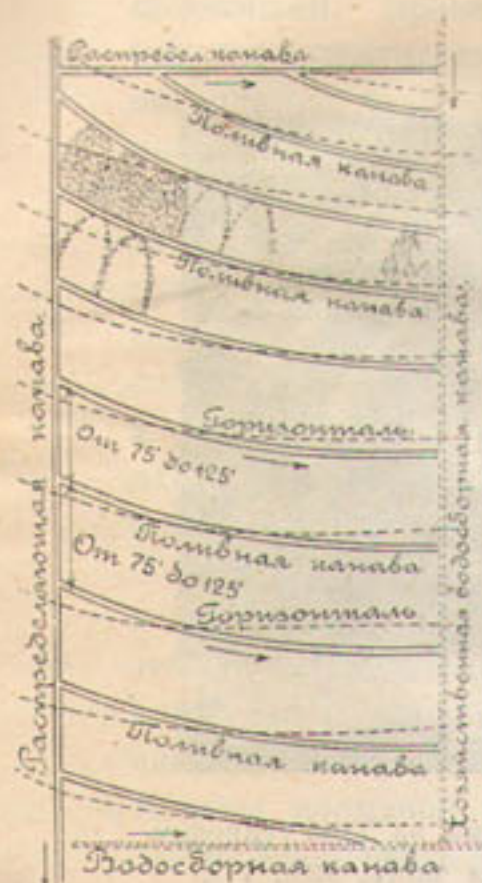
Чер. 215. Полив свободным напуском при поливной сети, проходящей поперек наибольшего уклона.
