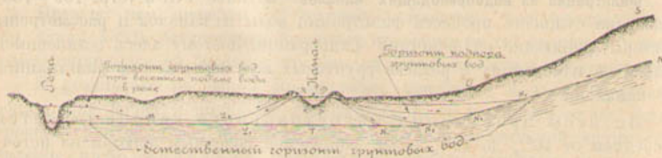
Черт. 277. Изменение естественного горизонта грунтовых вод, создаваемое фильтрационным потоком из магистрального канала.
