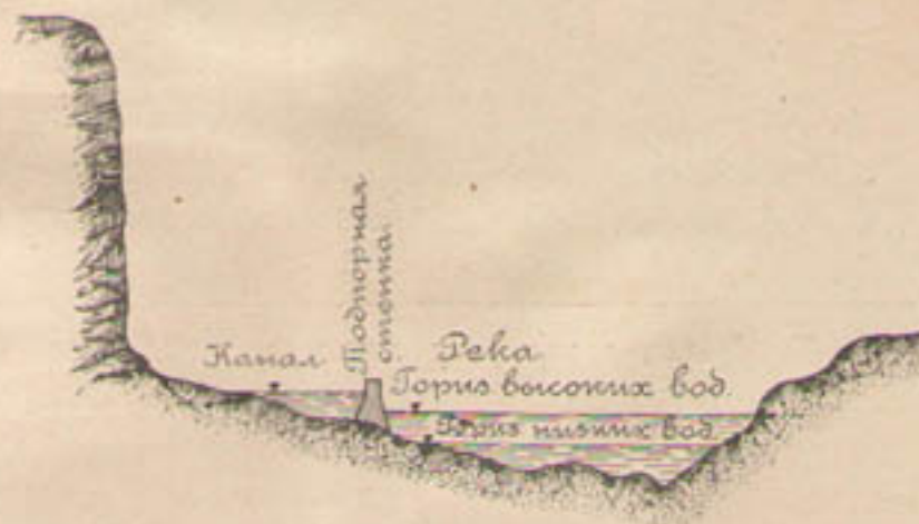
Черт. 153. Подпорная стенка в виде раздельной дамбы.
