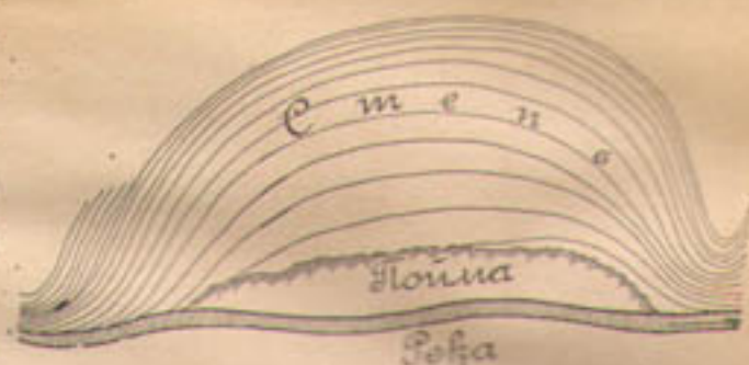
Черт. 67. Долинный тип рельефа, замкнутого с верховой и низовой стороны.
