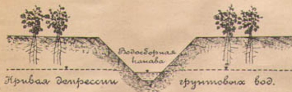
Черт. 39. Типовое поперечное сечение водосборной канавы.
