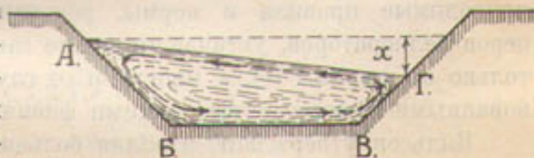
Черт. 180. Схема движения воды на закруглениях.
