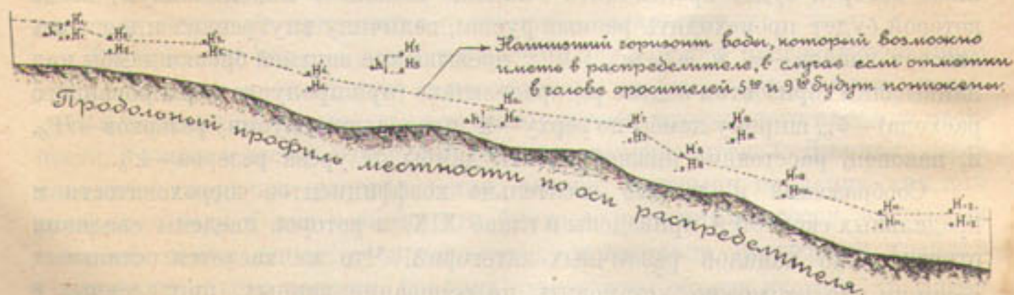
Черт. 209. Схема определения горизонтов воды в распределителе.
