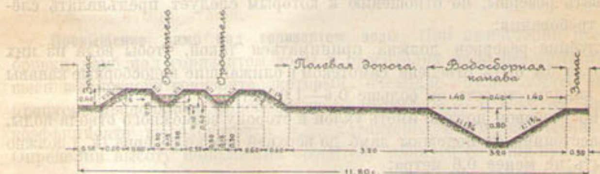
Чертеж 202. Полоса отчуждения, в случае если оросители двух соседних единиц водопользования и, кроме того, водосборная канава проложены рядом. (Размеры в саженях).
