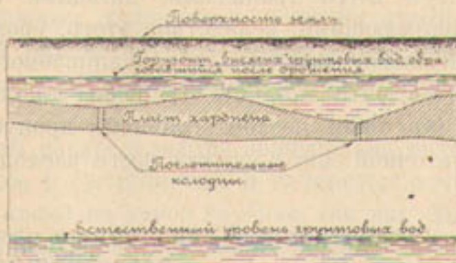
Черт. 289. Горизонт „висячих“ грунтовых вод, образовавшийся после орошения вследствие наличия слоя хардпена.
