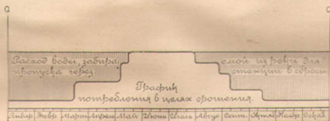
Черт. 82. Использование пропускной способности главного канала для работы гидроэлектрических станций на сбросах в случае избытка воды в источнике орошения.
