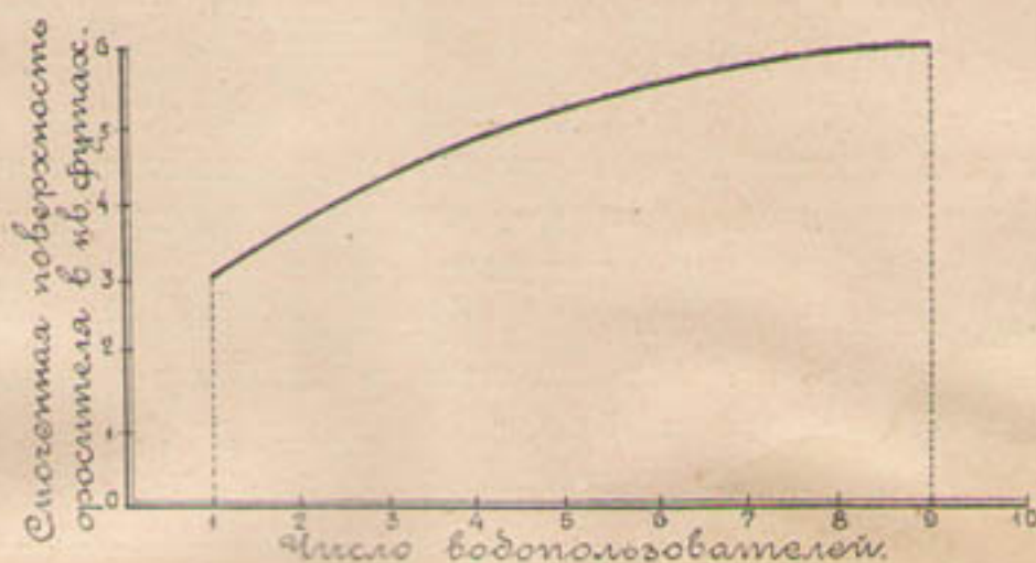
Черт. 128. Кривая зависимости величины смоченной поверхности от числа водопользователей, одновременно получающих воду.
