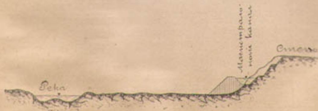
Черт. 34. Типовое поперечное сечение магистрального канала при прохождении им косогора.
