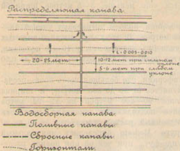
Черт. 244. Односкатная естественная система в ровной местности без водосборных канав на каждой делянке.
