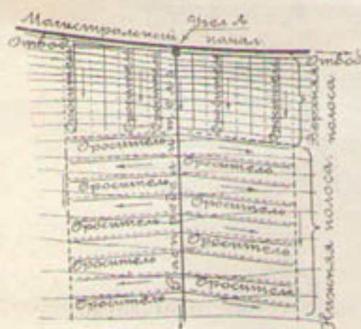
Черт. 187. Схема разбивки сети, с орошением верхней полосы из отвода, предусматривающая утилизацию гидравлической энергии.
