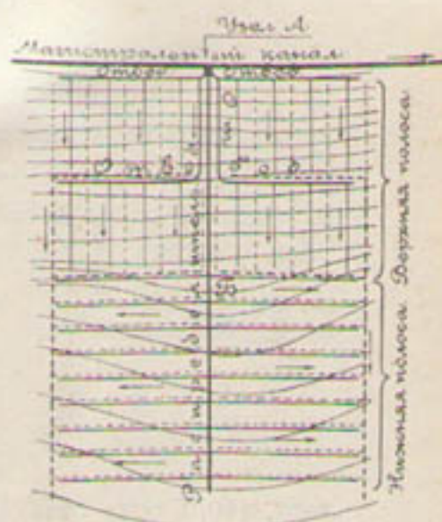
Черт. 188. Схема разбивки сети, с орошением верхней полосы из двух отводов, предусматривающая утилизацию гидравлической энергии.
