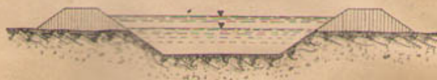
Черт. 37. Типовое поперечное сечение распределителя.
