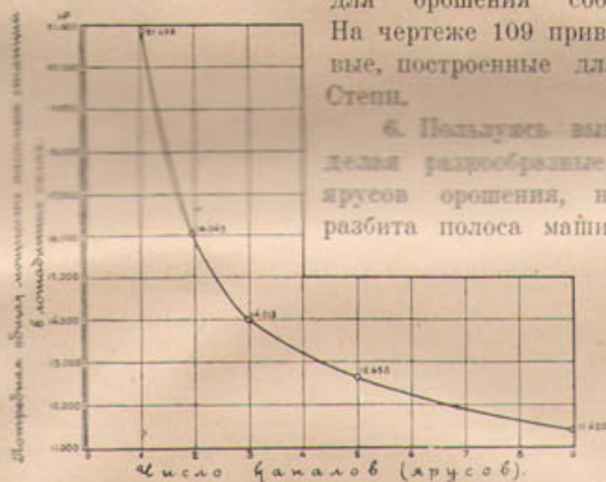
Черт. 110. Кривая зависимости между числом машинных каналов (ярусов) и общей мощностью насосных станций.
