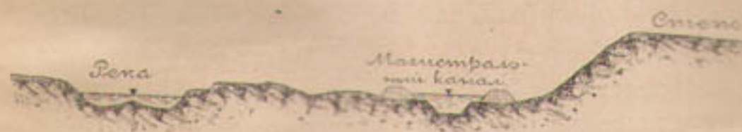
Черт. 33. Типовое поперечное сечение магистрального канала в пойме.
