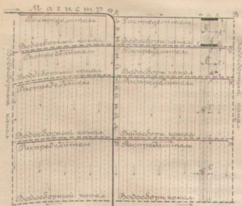
Черт. 185. Схема разбивки сети по второму типу.
