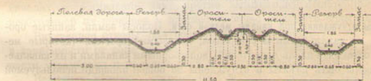
Черт. 204. Полоса отчуждения, в случае если оросители двух соседних единиц водопользования проложены вдали от водосборных канав. (Размеры в саженях).
