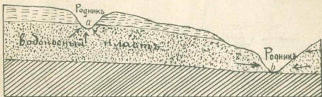
Черт. 48. Источники верхней и нижней воды одного и того-же водоноснаго слоя: а—родникъ верхней воды, б—родникъ нижней воды.
