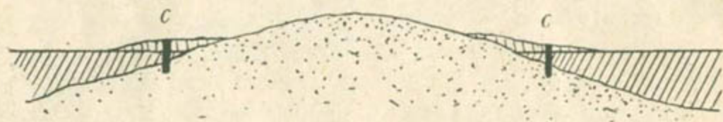
Черт. 19. Осложненіе бурового изслѣдованія, благодаря осыпямъ и вѣтровымъ отложеніямъ. У подножья песчанаго холма возможно ошибочное заключеніе о существованіи свиты трехъ пластовъ, вмѣсто дѣйствительно существующихъ двухъ.
