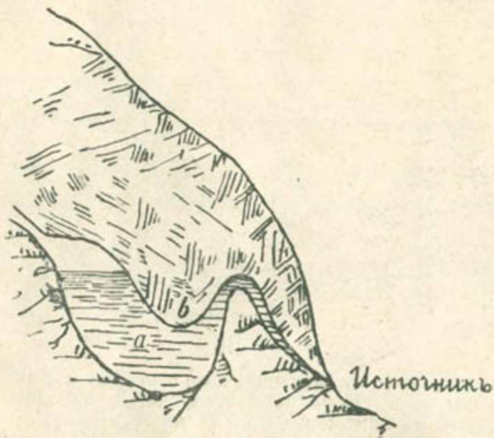
Черт. 29. Перемежающійся источникъ, функціонированіе котораго находится въ зависимости отъ уровня воды въ пещерѣ a .
