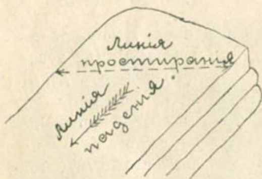
Черт. 13. Линія простиранія пласта, т. е. линія пересѣченія одного изъ боковъ (висячаго или лежачаго) пласта съ горизонтальною плоскостью, проведенною въ данномъ мѣстѣ пласта.
