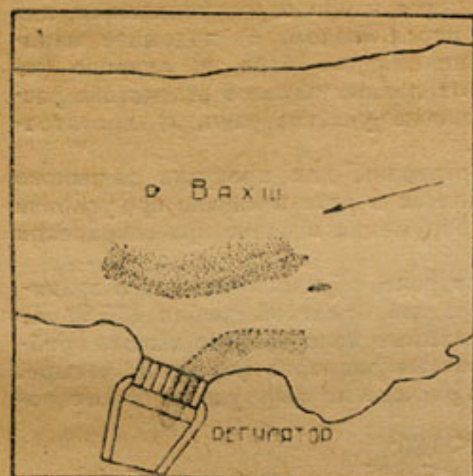
Рис. 11. Схема отложений донных наносов при отсутствии бара ниже поперечника № 4. Положение регулятора 1-ое Q реки = 100 \text{ м}^3/\text{сек.} , q канала = 51,5 \text{ м}^3/\text{сек.}
