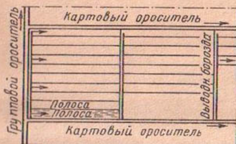
Рис. 18. Схема полива карты по полосам.
