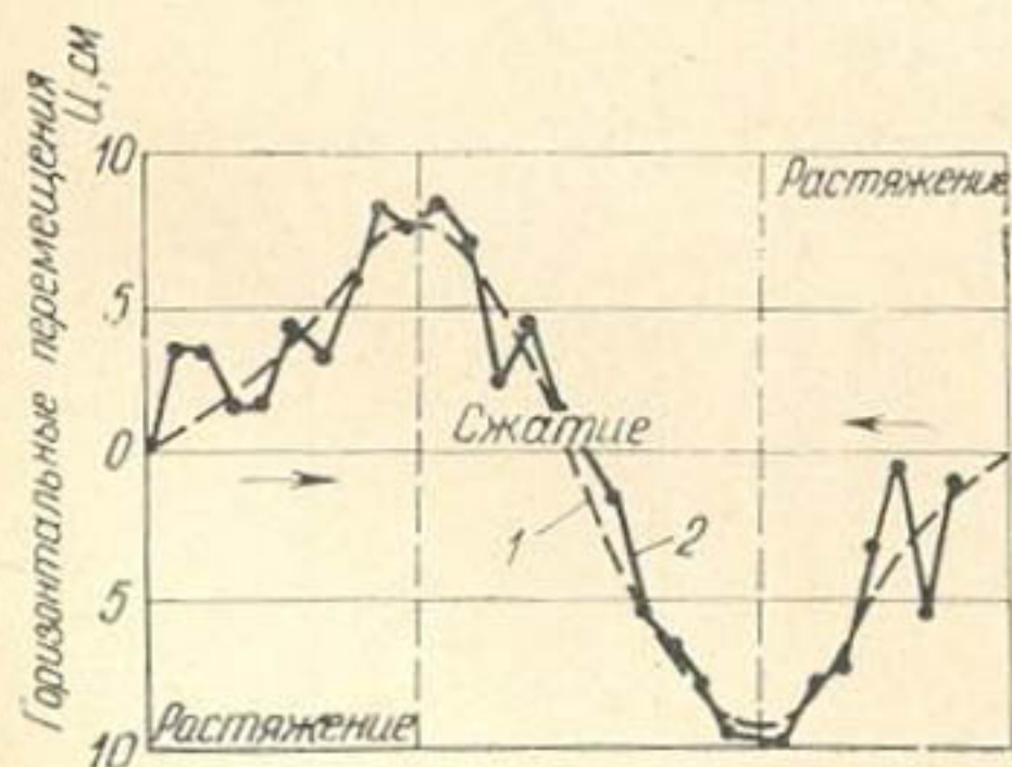
Рис. 1.2. График относительных продольных деформаций гребня плотины Инfernильо в период 1964 г.
