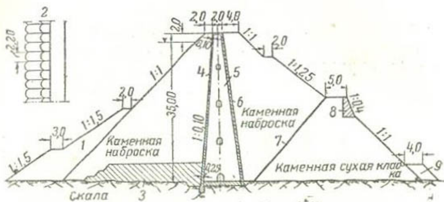
Рис. 58. Каменная плотина Уед-Кебир (L. Qued-Kebir), Тунис (Северная Африка)
