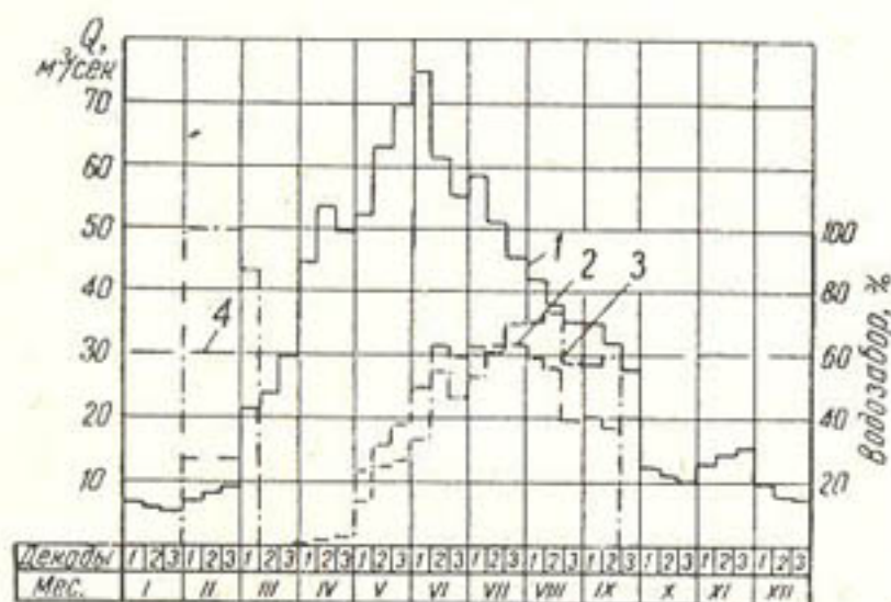
Рис. 29. Гидрографы р. Каратаг с подпитыванием из р. Дюшамбинки и водозабор в Тупалангский канал на гидроузле.
