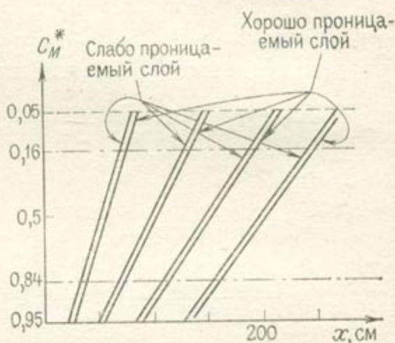
Рис. 2.5.4. Изменение концентрации водорода во времени в восьми точках измерения в четырех сечениях двухслойной модели (начальный импульс концентрации — ступенчатый, скорость постоянна)
