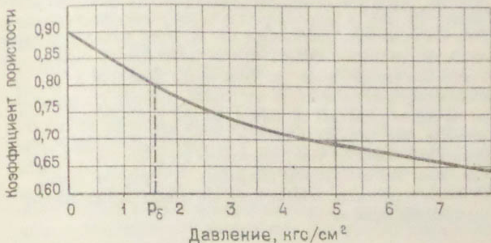
Рис. 2. Зависимость коэффициента пористости лесса от давления при насыщении его водой.
