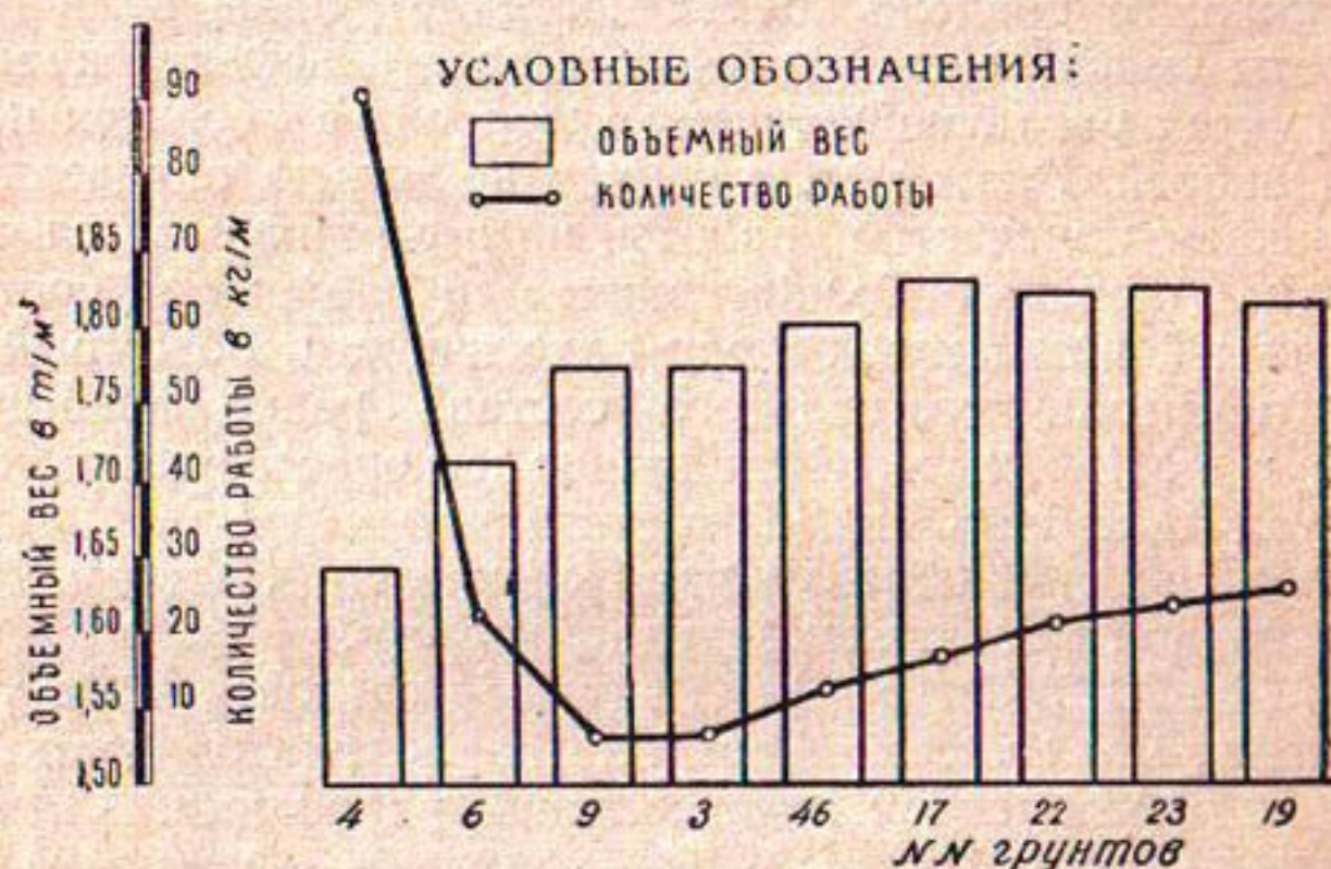
Р и с. 9. Предельная плотность грунтов различного солевого состава и количество работы, потребное для достижения \sigma = 1,6 т/м^3 при влажности, равной максимальной молекулярной влагоемкости.
