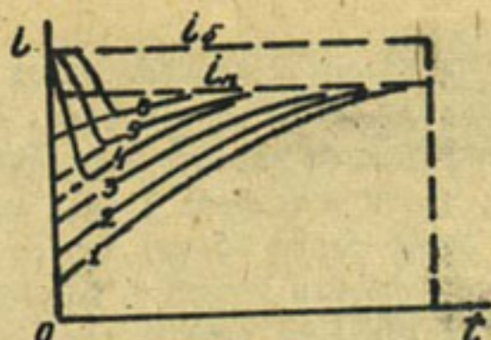
Рис. 1. Изменение во времени уклона водной поверхности на участке дополнительного подпора: 1, 2, 3, 4, 5, 6 – номера створов.
