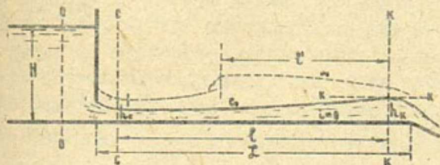
Рис. I. Формы кривых свободной поверхности потока в лотке за щитовым отверстием перед перепадом.
