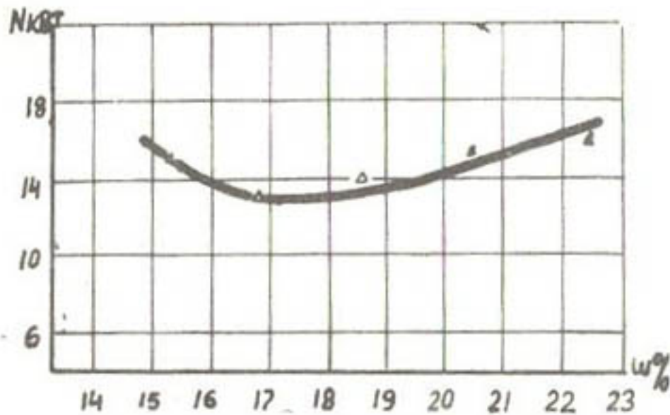
Рис. 1. Влияние влажности грунта наносов на потребляемую мощность рабочим органом
