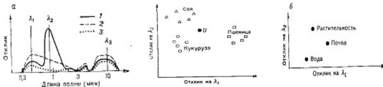
Рис. 2 - Положение отражательных откликов сельскохозяйственных культур в плоскости зеленого и ближнего инфракрасного диапазонов.
