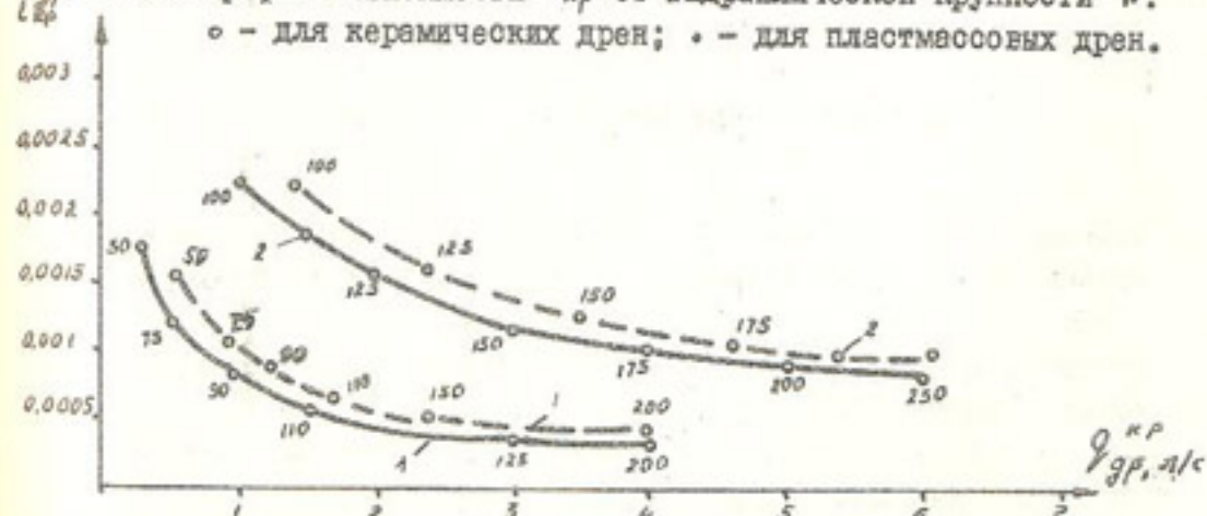
Рис. 3. График зависимости i_{кр} от q_{др} при W = 3,0 мм/с (1 — пластиковый дренаж с искусственным или комбинированным фильтром) и 8,0 мм/с (2 — керамический дренаж) (числа у линий — диаметры труб).
