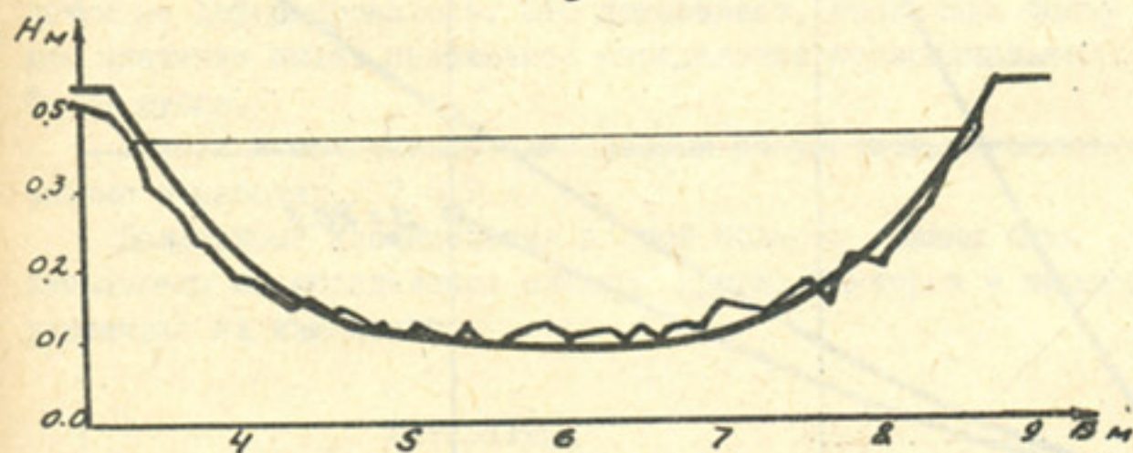
Рис.2. Совмещенные поперечные сечения русла канала до и после опыта: а) опыт №2, где \beta_0 = 15,0 ; v/v_0 = 1,2 ; б) опыт №7, в котором \beta_0 = 20,8 ; v/v_0 = 1,2 .
