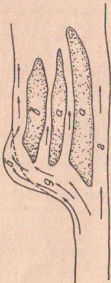
Рис. 2 Схема дельты II го типа; а - старые острова; б - зона размыва; в - новый остров; г - старый форватер; г - новый форватер.
