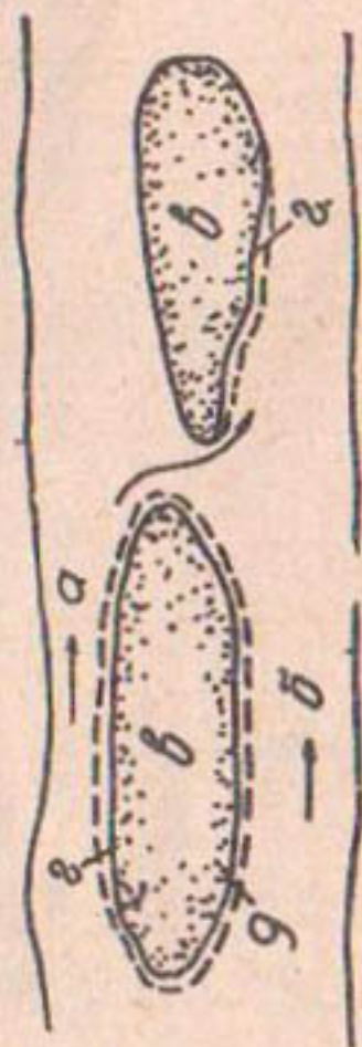
Рис. 6. Схема дейуща IV типа. а - фарватер \frac{1}{2} расхода; б - фарватер \frac{2}{3} расхода; в - астрава; г - зоны размыта; з - зона отложения.
