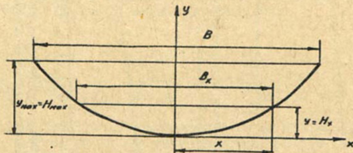
Рис. 6. Расчетная схема для определения параметра \alpha формы русла.
