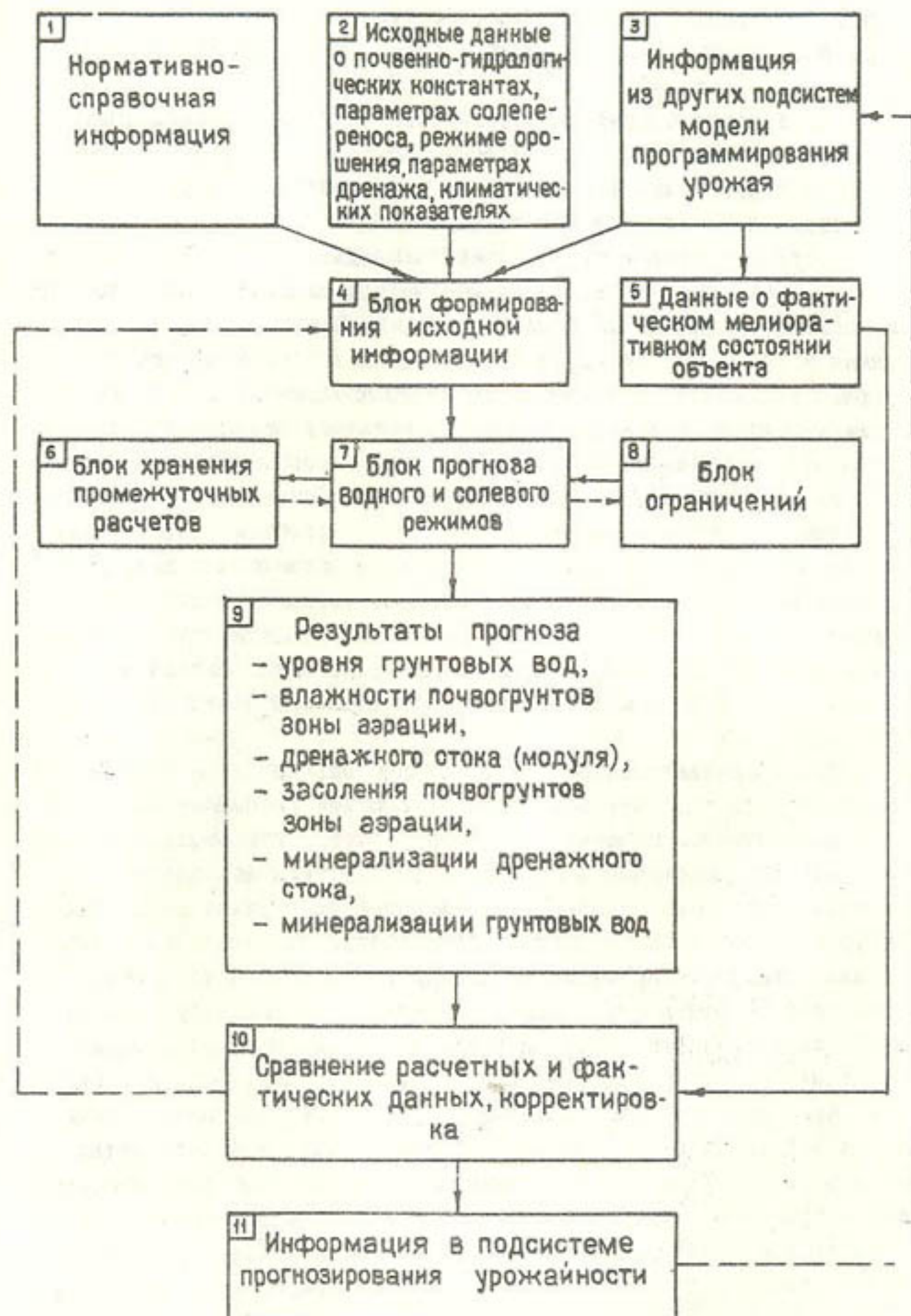
Рис. 1. Структурная схема модели мелиоративного состояния земель
