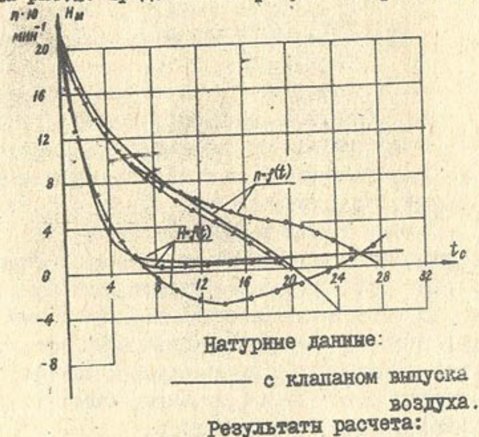
Рис. 2. Изменение давления в трубопроводе и частоты вращения отключенного насоса 2400В-25/40 при работающем насосе I600В-10/40 на ДГНС.
