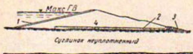
Рис. 30. Вариант плотины из суглинка на суглинном основании.
