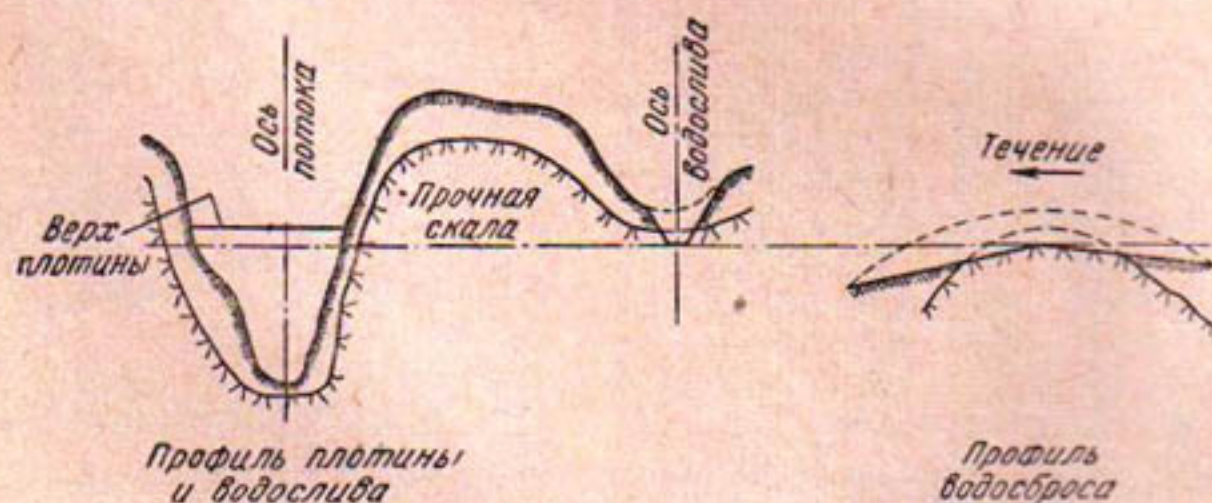
Рис. 60. Пример берегового водосброса в плотной скале.
