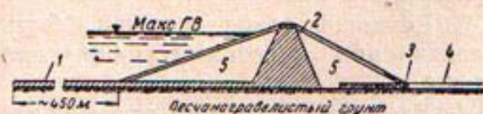
Рис. 29. Схема плотины на песчано-гравелистом основании.
