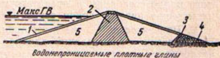
Рис. 28. Вариант плотины на непроницаемом основании.
