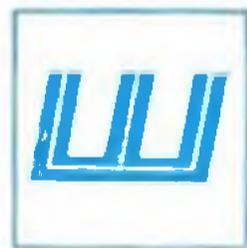
**ШАНДОРЫ**, горизонтальные брусья или балки различ. попереч. формы, предназначенные для перекрытия водопропускных отверстий ГЭС. Брусья (балки) укладывают горизонтально друг на друга в пазах *быков* или *устоев*, образуя шандорную стенку, иногда наываемую балочным затвором (см. рис.). Ш. бывают деревянные, железобетонные и металлические (клёпаные или сварные). Деревянные применяются при напорах 4—5 м, ширине перекрывае-
