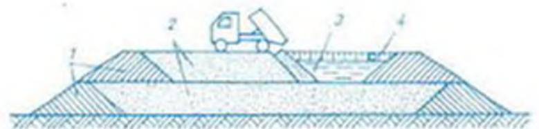
Рис. 4. Схема уплотнения грунта отсыпкой в воду ярусами до 4—5 м из автосамосвалов; 1 — дамбы обвалования; 2 — грунт, уложенный в воду; 3 — вода; 4 — труба для перепуска воды на соседние карты укладки.
