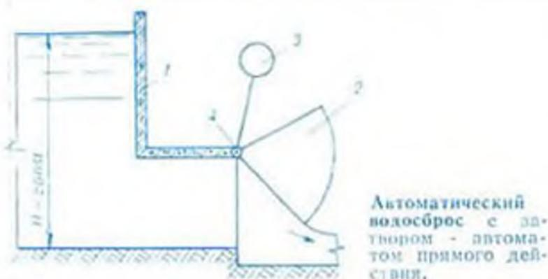
Автоматический водосброс с затвором - автоматом прямого действия.
