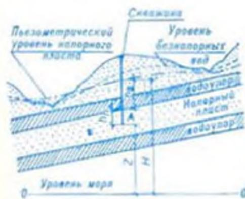
Схема напорного пласта:  $H$  — гидростатический напор;  $h_d$  — гидростатическое давление погружения;  $h_m$  — высота столба воды над кровлей пласта;  $z$  — превышение точки А над уровнем моря.
