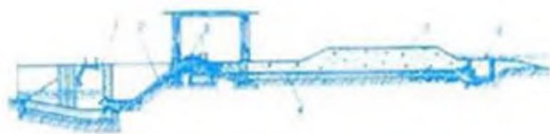
Схема стационарной насосной станции раздельного типа: 1 — всасывающий узел; 2 — всасывающий трубопровод; 3 — центробежный насос с электродвигателем; 4 — напорный трубопровод; 5 — ограждающая дамба, совмещённая с дорогой; 6 — водоподъёмное сооружение.
