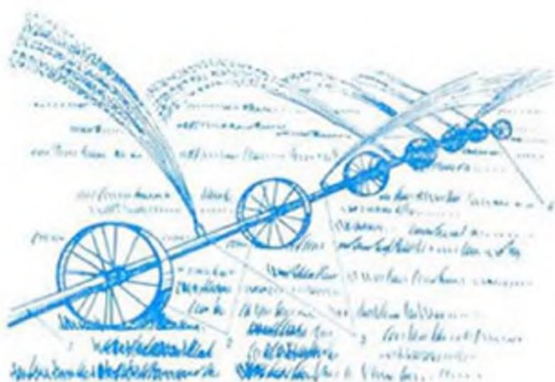
Рис. 2. Среднеуструйные дождевальные машины. Крыло многоопорной дождевальной машины ДКШ-61 «Волжанка»: 1 — поливной трубопровод; 2 — опорные колеса; 3 — среднеуструйные дождевальные аппараты; 4 — приподнятая тележка.
