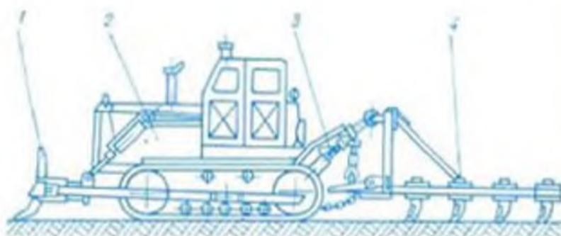
Корчевательный агрегат МП-8 с корчевательной бороней: 1 — корчеватель; 2 — трактор; 3 — гидроцилиндр управления корчевательной бороней; 4 — корчевательная борона.
