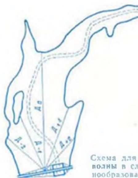
Схема для определения разгона волн в сложных условиях волнообразования.
