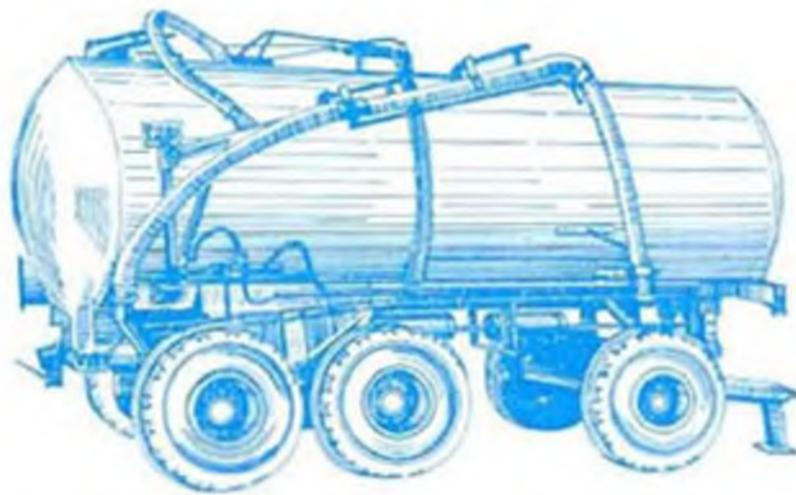
Рис. 2. Разбрасыватель жидких удобрений РЖТ-16.
