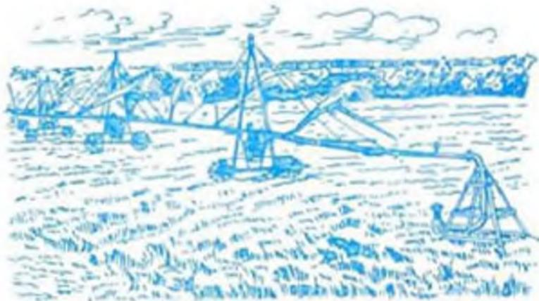
Рис. 1. Среднеструйная дождевальная машина «Фрегат».
