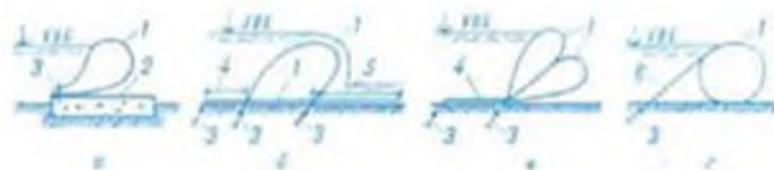
Водонаполняемая плотина: а — на бетонном флютбете, б — закреплённая по двум образующим, в — многооболочковая, г — с удерживающим пологим полотнищем или тросами; УВБ — уровень верхнего бьефа.
