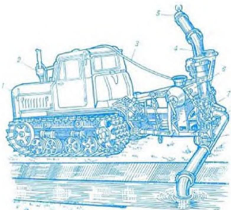
Рис. 1. Дальнеструйная дождевальная машина ДДН-70: 1 — трактор ДТ-75; 2 — вакуум-аппарат; 3 — вакуумный трубопровод; 4 — ствол с дождевальным аппаратом; 5 — большое сопло; 6 — приспособление для внесения удобрений; 7 — насос-редуктор; 8 — рама; 9 — всасывающий трубопровод.
