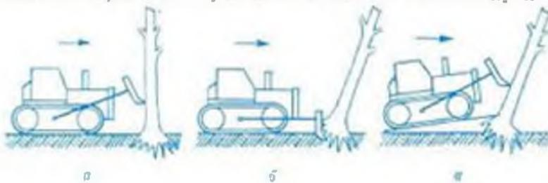
Рис. 1. Культуртехнические работы. Способы валки деревьев: а — наклоном дерева; б — корчёвкой дерева; в — наклоном дерева с подсыпкой.
