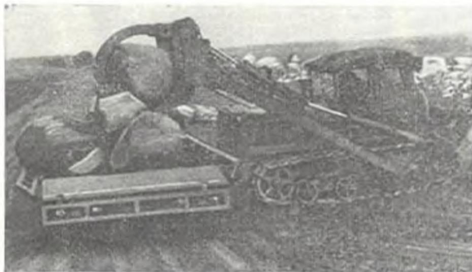
Культуртехнические работы: уборка камней с помощью погрузчика и прицепа ПК-5; планировка поверхности длиннобазовым планировщиком Д-719.
