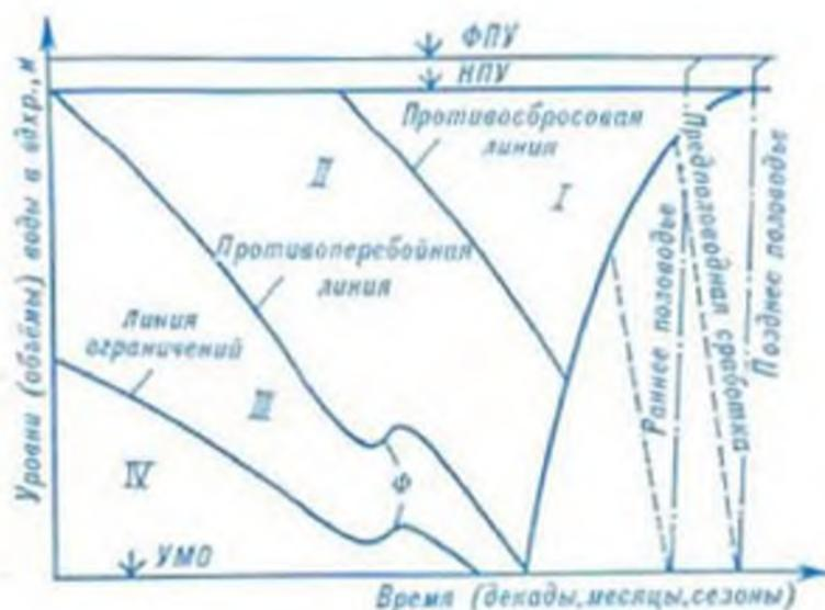
Диспетчерский график работы водохранилища при сезонном регулировании стока: I — зона полной повышенной отдачи; II — зона повышенной отдачи; III — зона гарантированной отдачи; IV — зона ограниченной отдачи; Ф — возврат фильтрационных и сбросных вод в водохранилище; ФПУ — форсированный подпорный уровень; НПУ — нормальный подпорный уровень; УМО — уровень мёртвого объёма.
