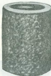
Рис. XXX-20. Бетонный пористый фильтр.
