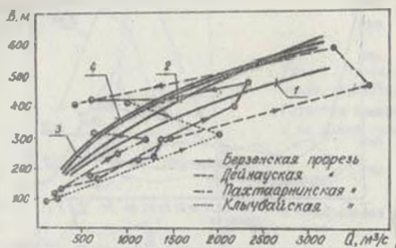
Рис. 3. Графики изменения ширины прорези в зависимости от расхода воды
