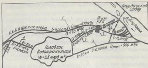
Рис. 2. Схема комплекса сооружений на головном участке Каракумского канала
