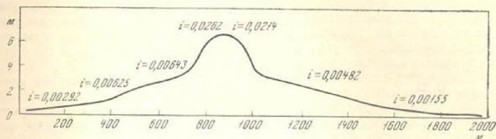
Рис. 22. Поперечный профиль вала в 2,5 км к юго-западу от Мессаряна ( $i$ -уклоны поверхности вала, в тысячных)
