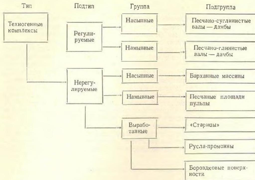
Регулируемые техногенные комплексы представлены дамбами, окаймляющими канал почти на всем его протяжении. По способу сооружения различаются насыпные и намывные комплексы дамб.
