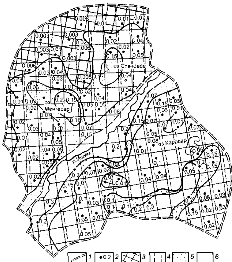
Рис. 13.1. Распределение величин инфильтрационного питания на территории Приишимской равнины (южная часть Западно-Сибирской низменности): 1 — границы расчетного участка; 2 — расчетный блок, цифра — величина инфильтрационного питания, л/с · км 2 ; 3—6 — величины инфильтрационного питания, л/с · км 2 : 3 — менее 0,01; 4 — 0,01—0,1; 5 — 0,1—0,2; 6 — 0,2—0,5
