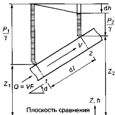
Рис. 5.1. Установившееся ламинарное движение жидкости в цилиндрической трубке (по Р. де Уисту, 1969)
