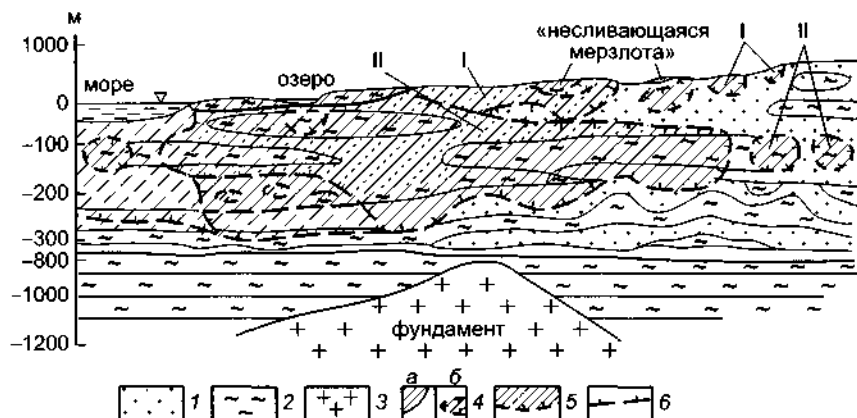
Рис. 12.3. Строение криолитозоны платформенных областей (по Н.Н. Романовскому, 1983): I — плейстоценовые, II — верхнеголоценовые мерзлые толщи; I — преимущественно песчаные водоносные породы; 2 — глинистые слабопроницаемые; 3 — породы фундамента; 4 — слой сезонного промерзания (а), многолетнемерзлые породы (ММП) и граница их распространения (б); 5 — охлажденные породы с криогалинными водами и граница их распространения; 6 — граница между плейстоценовыми и верхнеголоценовыми ММП
