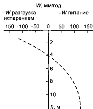
Рис. 7.6. Характер изменения величины инфильтрационного питания и разгрузки грунтовых вод испарением в зависимости от глубины их залегания (по И.С. Пашковскому)
