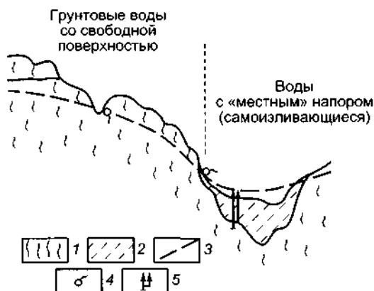
Рис. 9.3. Схема разгрузки грунтовых вод зоны экзогенной трещиноватости: 1 — трещиноватые скальные породы, 2 — рыхлые слабопроницаемые отложения, 3 — уровень грунтовых вод, 4 — источник, 5 — скважина, стрелка — величина местного напора подземных вод
